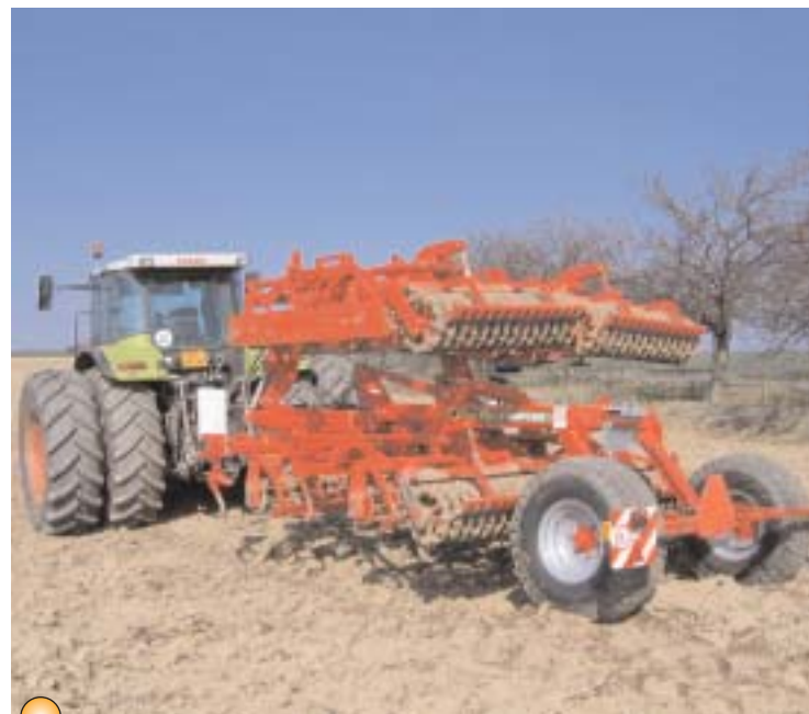
● Hydraulický okruh zajišťuje pohodlné skládání a rozkládání pracovních sekcí i přepravního podvozku
