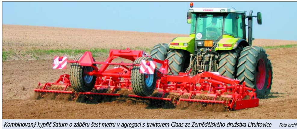
Kombinovaný kypřič Saturn o záběru šest metrů v agregaci s traktorem Claas ze Zemědělského družstva Litultovice Foto archiv
