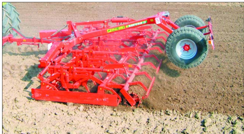
Saturny vynikají hlavně kvalitním urovnáním povrchu a další výhodou je přesné nastavení pracovní hloubky Foto archiv
