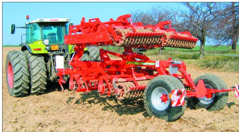
Hydraulický okruh zajišťuje pohodlné skládání a rozkládání pracovních sekcí i přepravního podvozku Foto archiv
