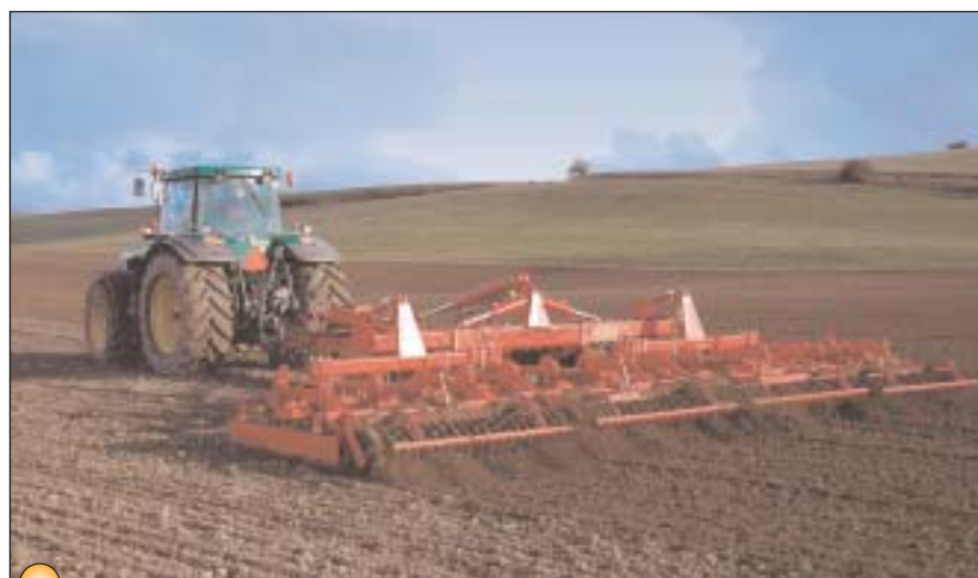
● Kombinovaný kypřič NEPTUN II 8P o pracovním záběru 8 metrů
